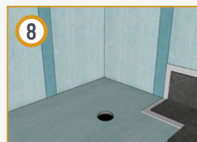
8 Приступить к монтажу настенной и напольной плитки
