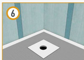
6 В местах выхода труб из пола наклеить манжету TH2 Stop Floor Collar
